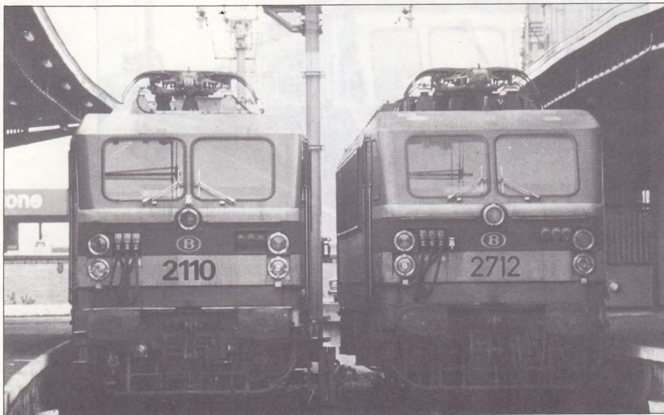
NMBS : De 3150 kW locomotieven reeks 21 (BN-ACEC, 1984-87) zijn uiterlijk slechts op kleine details te onderscheiden van de 4150 kW reeks 27 (BN-ACEC, 1981-84), Oostende 03/85.
