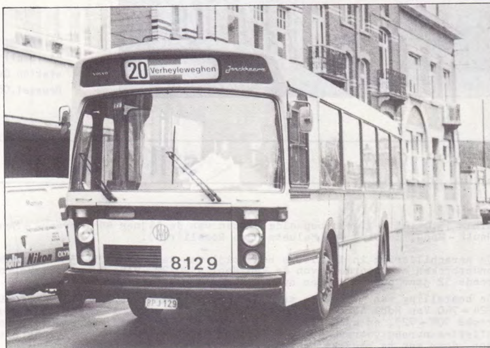
MIVB : AB 8129 (Volvo B59-55-S - Jonckheere, 1976) met als proef een tweekleurige lijnfilm met links lijncijfer. St-Agatha-Berchem, Soldatenstraat, 12.84.
