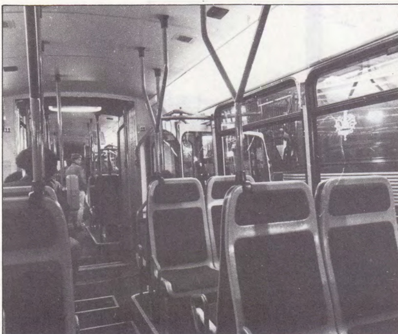
Interieur van een gelede MIVB autobus. Bemerkt het nieuwe zeteltype, de boven de deuren doorlopende verlichting, en de speciale vormen van de handgrepen.
