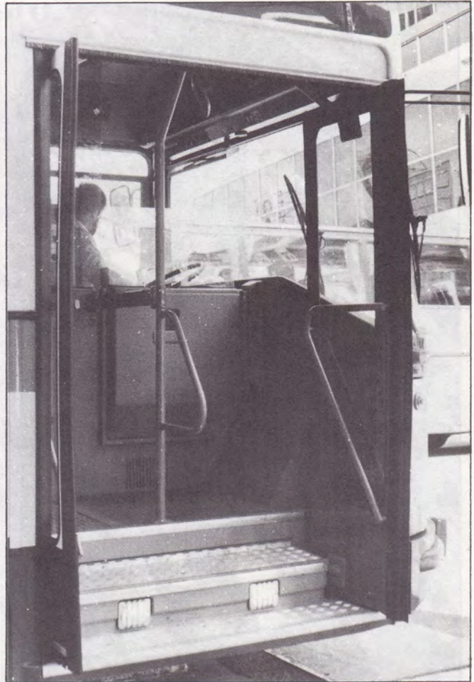
Het voorplatform van een gelede MIVB autobus. De bestuurderscabine wordt met een betaaltafel-deur volledig afgesloten. Brussel, 08.85.
